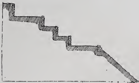
Coupe d'une andeneria (gradins en maçonnerie sur le versant d'une montagne).
